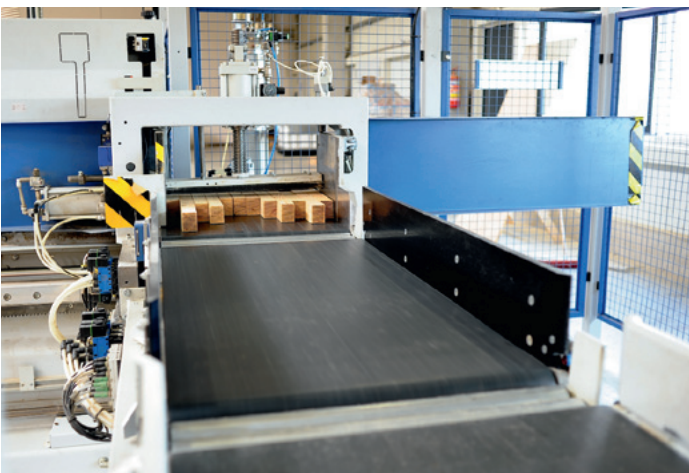
Flexibel: Die kleinere der beiden Grecon-Keilzinkenlinien gefällt vor allem durch ihre Anpassungsfähigkeit ohne aufwändige Rüstarbeiten
